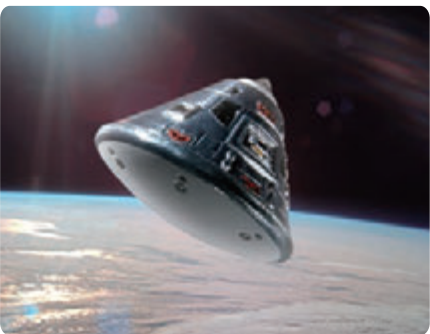
司令船(CM: Command Module)は、昇降とそのための居住区画の二重構造をしており、宇宙飛行士の生命を守る。宇宙飛行士3名の搭乗が可能。地球に最終的に帰還するのはコマンドモジュールのみである。
