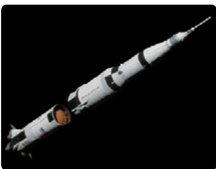
S-ICは、発射時には、最初に着陸し、そして巨大なタンクに満たした燃料をたった約2分間で使い切り、燃焼を終える。到達高度は38マイル (61.14km) である。
