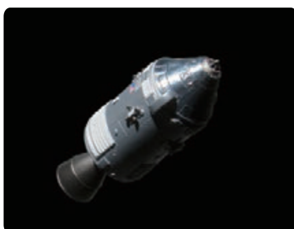
支援船(SM: Service Module)は、大気圏突入直前まで司令船に接続され、司令船に推進、水と電力を供給する。また、支援船にはRCS(Service Propulsion Subsystem)エンジン、および16基の RCS (Reaction Control Subsystem) エンジン、そしてこれらに必要な燃料、酸化剤、ヘリウムを搭載し、地球に帰るまでに必要な軌道の制御と姿勢制御を行う。
