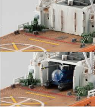
格納ハッチは開閉可能。内部にはヘリコプター2機を搭載可能。
